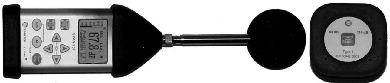
31 pav. SVAN 957 Triukšmo ir vibracijos matuoklis.
